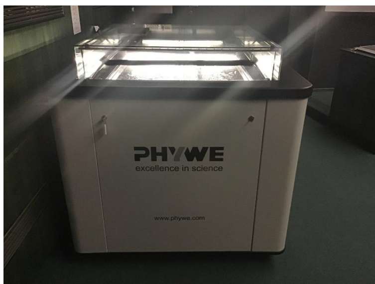
Obr. 15: Mlžná komora v Informačním centru Jaderné elektrárny Temelín. Foto autorka
