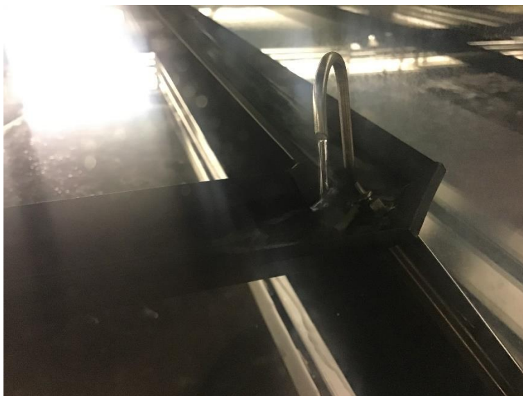
Obr. 16: Dávkořač isopropylalkoholu v mlžné komoře. Foto autorka
