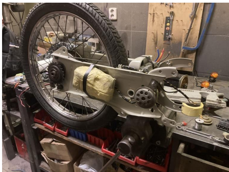
Obr. 20: Zkouška nejvhodnějšího rozložení komponentů pro elektrifikaci 51
