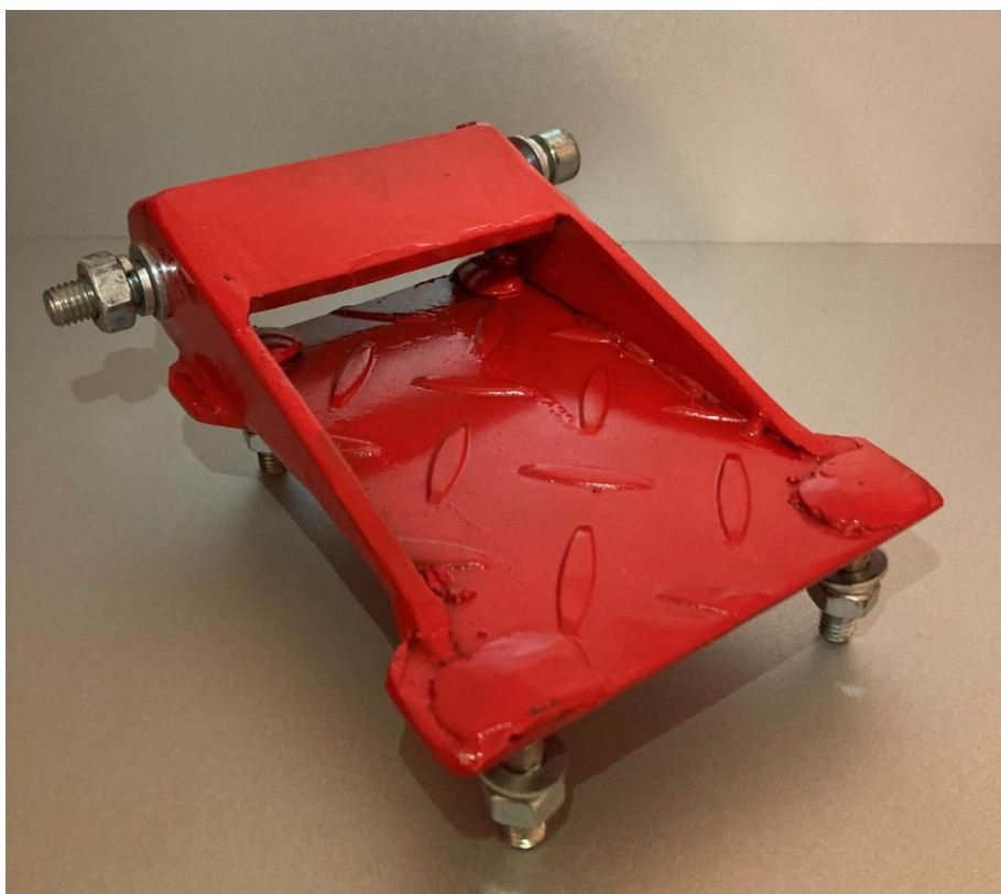
Obr. 23: Vyrobené díly pro uchycení kyvné vidlice 54
