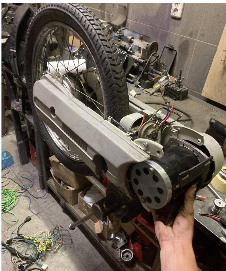
Obr. 21: Rozměření potřebných vzdáleností pro uchycení motoru 52
