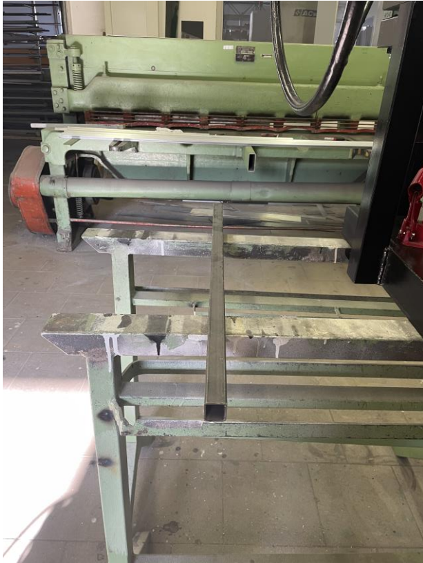
Obrázek 44 Čtvercový profil před ohnutím
