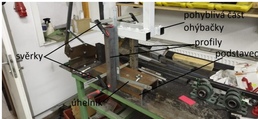
Obrázek 26 Příprava na svařování delších profilů k podstavci
