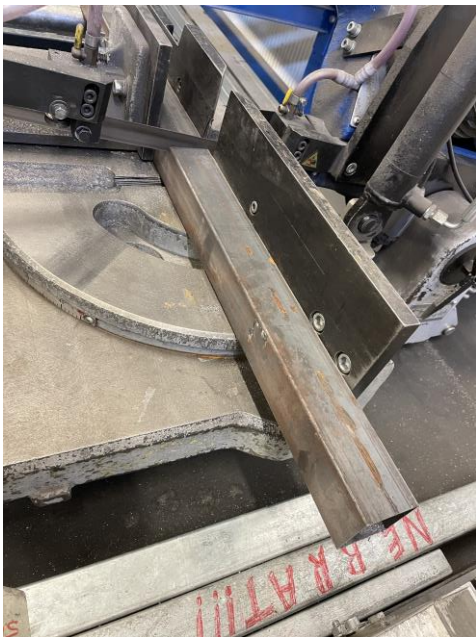
Obrázek 18 Řezání delších profilů
