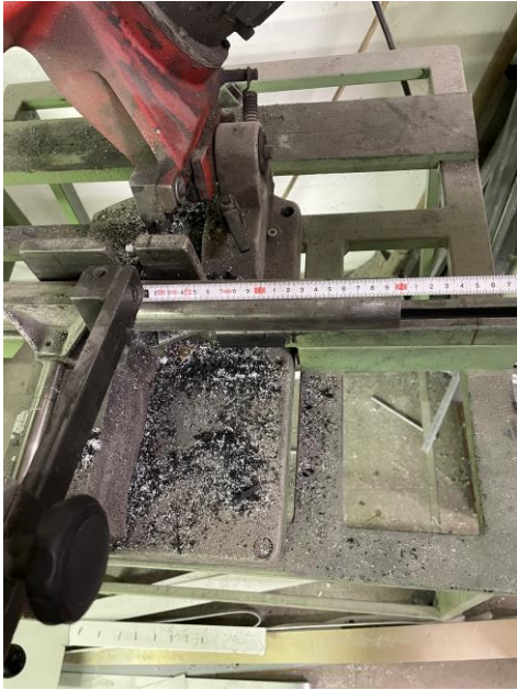
Obrázek 9 Řezání ocelové tyče
