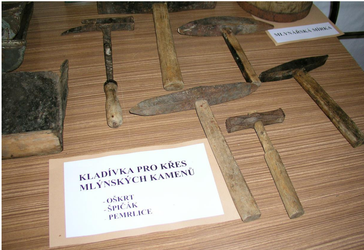
Obrázek 10: Kladívka pro křes mlýnských kamenů – oškrt, špičák, pemrlice.
